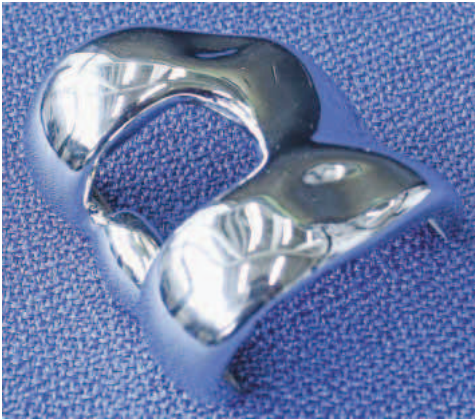
Solche Knierohlinge aus einer Cobalt-Chrom-Legierung fertigt Aesculap im Laserschmelz-Verfahren in Kleinserien Bild: Aesculap
